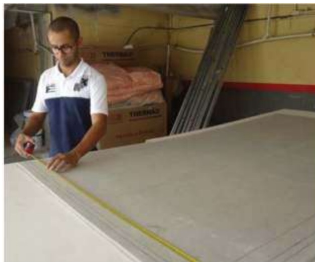
Figura 3 - Detalle de determinación del ancho de la placa
