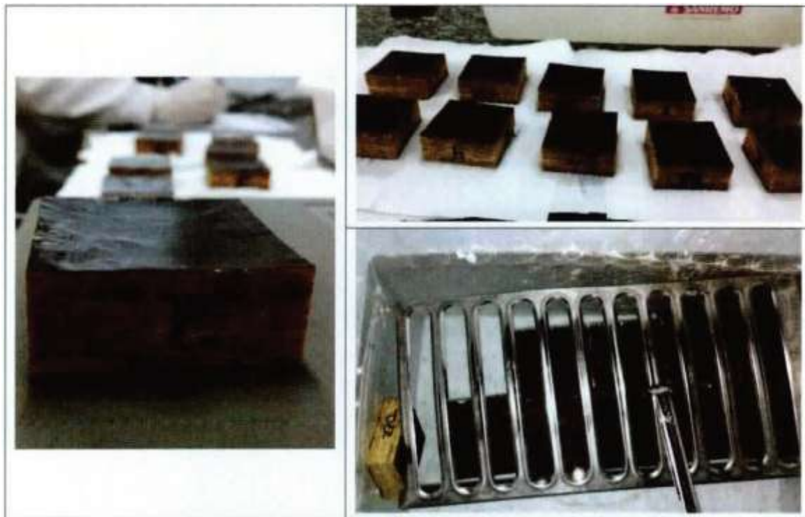
Figura 2 - Detalhes del ensayo de hinchazón de la muestra 1293/36
