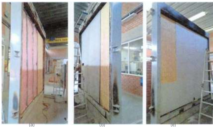
Figura 1 – Detalle del sistema —cara expuesta al fuego: (a) distancias entre montantes y placa de compensado OSB; (b) membrana hidrófuga y Siding Vinílico; (c) placa de compensado OSB
