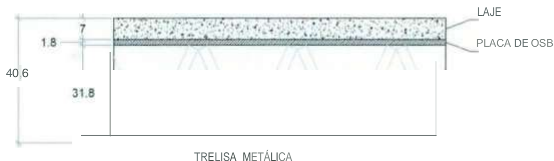
Figura 1-Corte esquemático del sistema de piso
