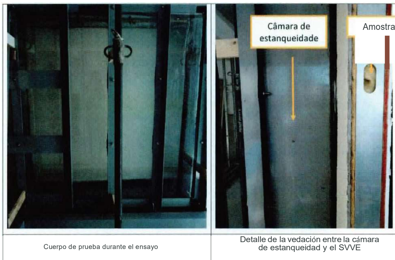
Figura 3 – Detalhes da avaliação dos sistemas sob ensaio de estanqueidade
