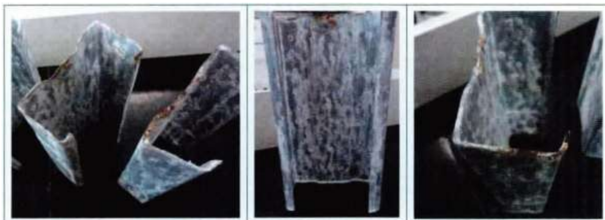
Figura 9 - Detalle de corrosión roja en la sección de corte después de 720 horas (muestra nº 1293109) Tabla 11
