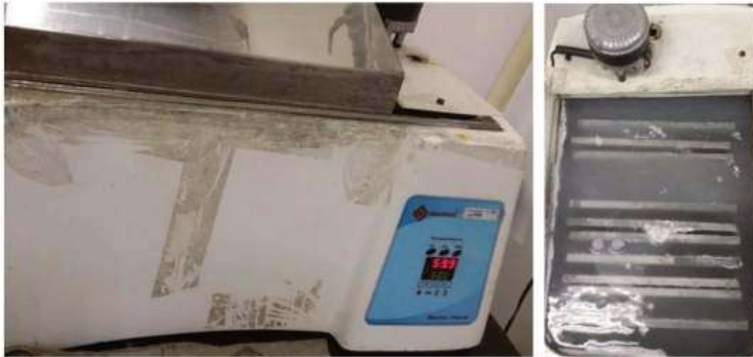
Figura 18 – Equipamiento de ensayo de envejecimiento por inmersión en agua caliente
