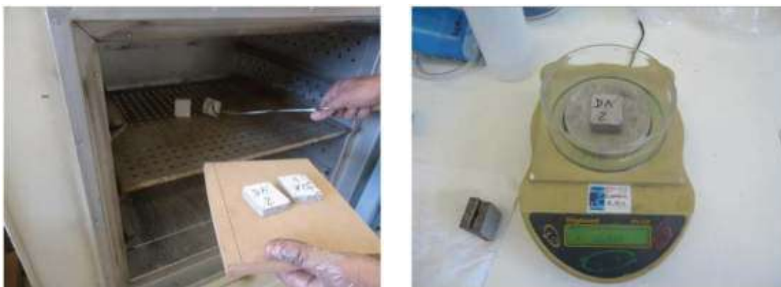
Figura 8 - Detalhes do ensayo de absorao de água Tabla 9 -
