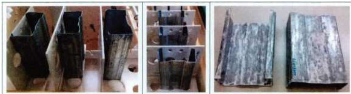
Figura 8 - Determinación de resistencia a corrosión - después de 360 hs (muestra No. 93109)
