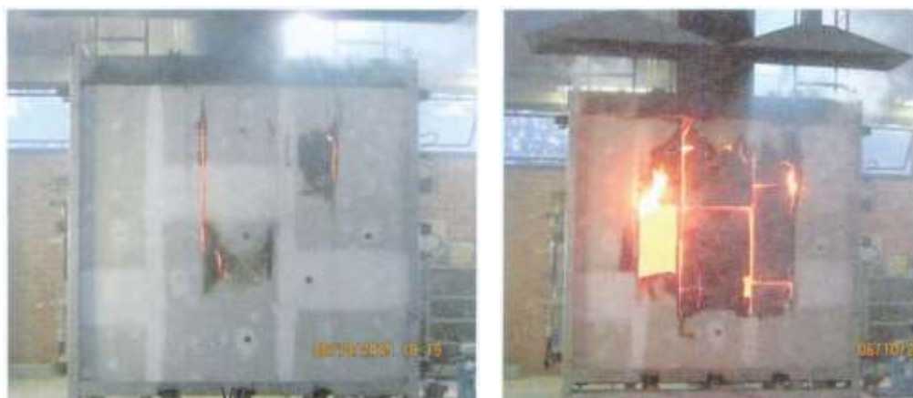
Figura 9 - Aspecto de la muestra durante la exposición al fuego
