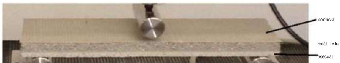
Figura 20 - Detalhe do corpo de prova de placa cementicia, com revestimiento.
