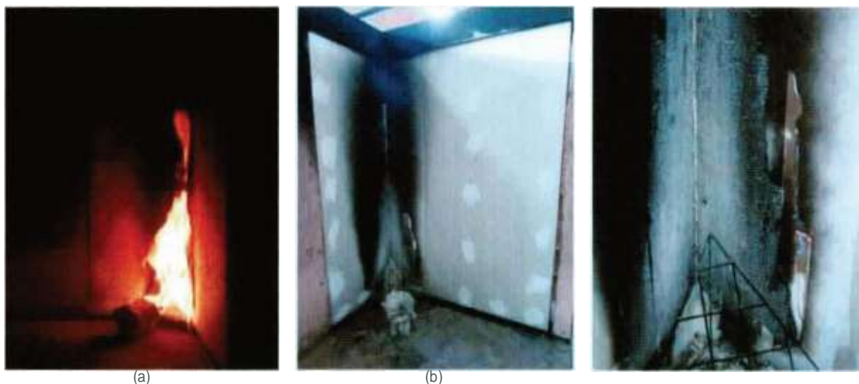
Figura 4 – Aspecto final de las muestras (a) durante y (b) después de los ensayos e (c) detalle del área de quema
